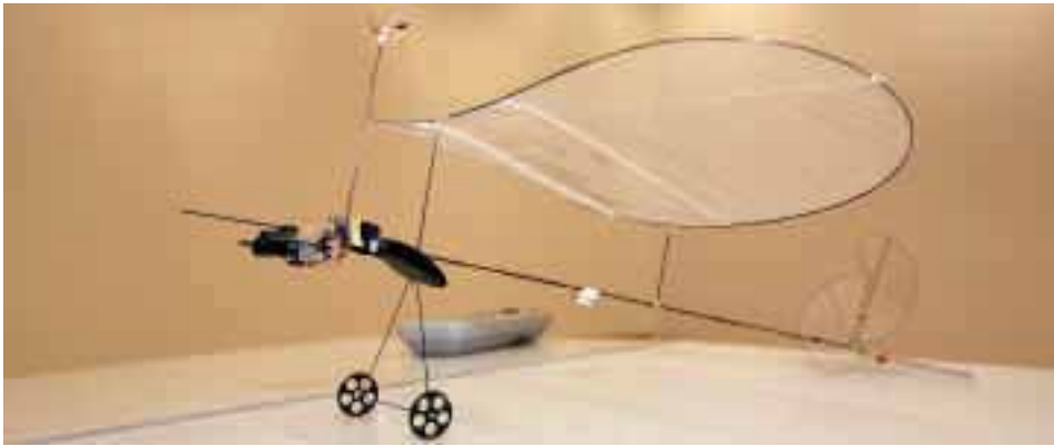
Der zehn Gramm leichte Miniroboter hat Kamera-Augen und kann in geschlossenen Räumen herumfliegen.
