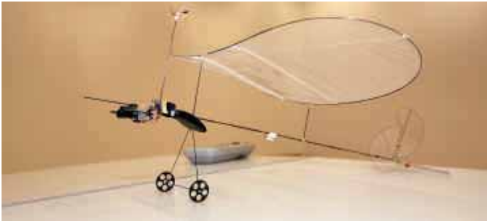
Le microrobot de dix grammes est muni de caméras qui fonctionnent comme des yeux et qui lui permettent de s'orienter.
