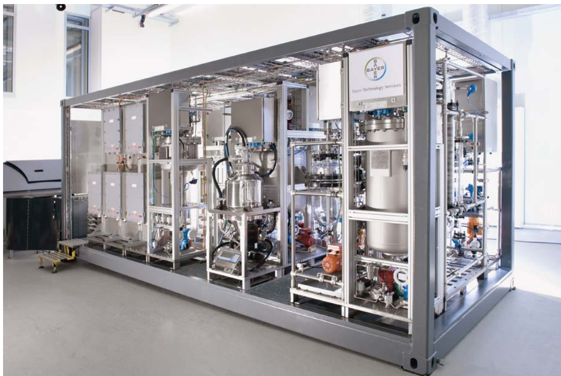
La vision du projet européen F3: une mini-usine chimique standardisée et transportable par container.
