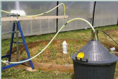
Die Schadstoffe sickern durch das Stück Boden, werden aufgefangen und analysiert.
