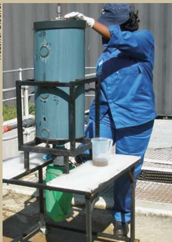
Dieser Reaktor wandelt Urin in den festen und sicheren Dünger Struvit um.
