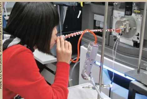
Der Atemtest mit dem Massenspektrometer erlaubt, Lungenerkrankungen zu erkennen.
