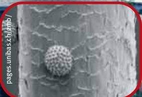
Der Durchmesser eines menschlichen Haars beträgt etwa 60 Mikrometer (500-fache Vergrösserung).
