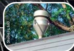
Eine **Messstation** saugt Luft durch einen Feinstaubfilter. Täglich wird das Gewicht der darauf abgelagerten Feinstaubmenge gemessen.
