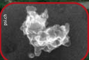
Dieser Dieselrußpartikelklumpen ist etwa 0,2 Mikrometer gross, also 100 mal kleiner als die Pollenkörner (100000-fache Vergrösserung).
