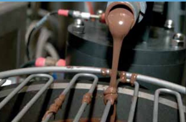
Schokoladenkreation im Labor: Im Vorkristallisator (unten links) lassen sich die Eigenschaften der braunen Masse festlegen, später wird sie zu Tafeln gegossen und bei 18 Grad gelagert (oben).
