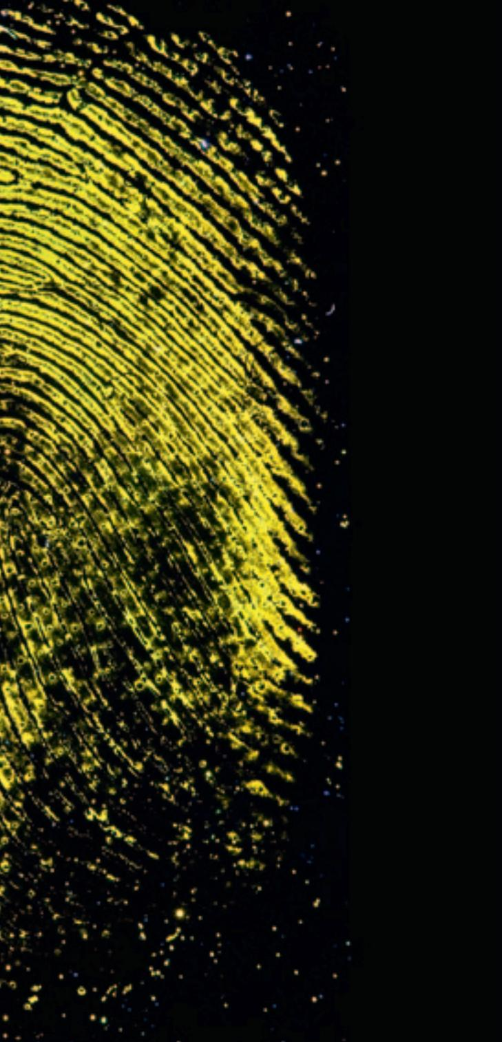
zum Nachweis von Fingerabdrücken am Tatort verwenden, messen zwischen einem und zehn Mikrometer. Die Papillarleisten, das heisst die Hautlinien, die den Fingerabdruck bilden, sind zwischen 300 und 400 Mikrometer breit. Mit den Nanopartikeln kann also eine bessere Auflösung der Linien erreicht werden, was bei der Auswertung der Spuren entscheidend sein kann.
