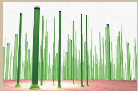
Höchst effizient: Solarzelle aus Nanodrähten und Siliziumsubstrat.
