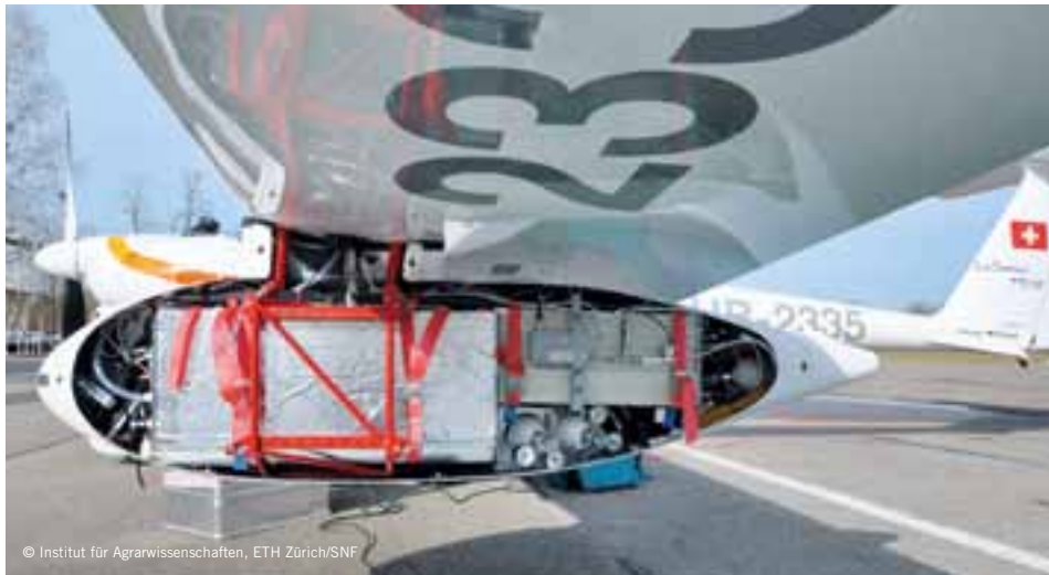
Fliegendes Analyselabor: Die Messinstrumente in den Behältern unter den Flügeln ermitteln während des ganzen Fluges die Methan- und Kohlendioxidkonzentrationen in der Luft.
