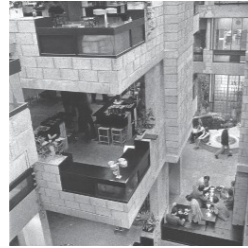
Modularität Modulare Grundstruktur als Rahmen für Nutzungseinheiten, Kollektiver Erschliessungsraum. H. Hertzberger, Centraal Beheer, Apeldoorn 1972
