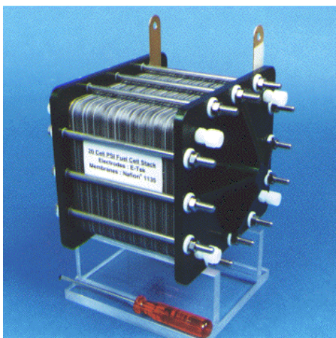
Figur 13: Mit Wasserstoff und Luft betriebener 1kW-Brennstoffzellenstapel, entwickelt am Paul Scherrer Institut in Zusammenarbeit mit der ETH Zürich (Bild PSI)
